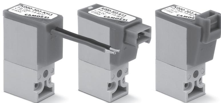
Электропневматические распределители прямого действия Серии К могут работать на воздухе как с распыленным маслом, так и без масла. Они поставляются 3/2 лин./поз. нормально закрытые или нормально открытые. Монтажные плиты могут быть как одноместными, так и многоместными. На эти плиты можно монтировать и Н.З. и Н.О. клапаны (но для последних нужен специальный переходник).
