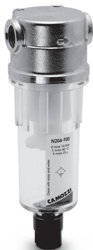
Фильтры Серии N поставляются с присоединительными размерами G1/8 и G1/4. Прозрачный стакан позволяет легко определить уровень конденсата. Фильтры Серии N оснащены ручным / полуавтоматическим клапаном слива. Доступны три вида фильтрующих элементов: 25 мкм, 5 мкм и 0.01 мкм.
