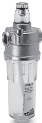
Маслораспылители Серии N поставляются с соединительными размерами G1/4 и G1/8. Расход масла можно регулировать винтом в верхней части корпуса маслораспылителя и контролировать по частоте падения капель внутри прозрачного колпачка. Заливка масла производится через заглушку в верхней части корпуса при отключенном давлении. Маслораспылители имеют корпус из латуни и стакан из технополимера.
