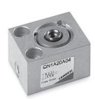
Цилиндры пневматические короткоходовые Серии QN предназначены для монтажа в ограниченном пространстве. Стандартные величины ходов штоков указаны ниже в таблице. Благодаря компактности и жесткости эти цилиндры в основном используются в механизмах фиксации и зажима.
