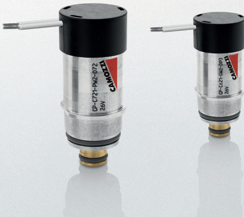
Пропорциональные клапаны прямого действия **Серии CP** могут использоваться там, где требуется управление потоком разомкнутого контура, газовыми смесями или для управления расходом. Клапаны Серии CP были разработаны с оптимизированными размерами и уменьшенным трением и сниженным эффек-
