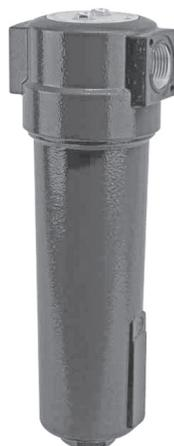
Циклонные сепараторы разработаны для высокоэффективного удаления влаги из систем сжатого воздуха и вакуумных систем. В корпусе расположены лопасти, которые задают проходящему воздуху вихревое движение. В результате центробежных сил частицы влаги (масло и воздух) циклонного сепара-
