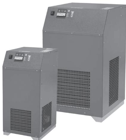
Серия RD разработана для быстрого и лёгкого осмотра системы осушителя и проведения сервисных работ. Быстроснимаемые панели дают непосредственный доступ к компонентам устройства. Очистка соленоида сливного клапана не требует использования инструментов и производится с помощью "соединительного штифта" стержня клапана и инновационного зажима катушки. Осушители RD превос-
