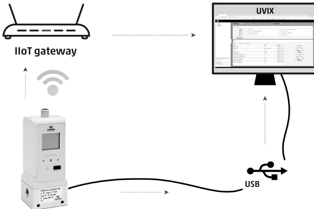
В дополнении к прогнозирующему обслуживанию клиент также получает доступ ко многим другим параметрам устройства, например, температуре, регулируемому давлению, отработанным часам и прочим характеристикам. Данные доступны пользователю через программное обеспечение «Универсальный графический интерфейс X», сокращенно UVIX, которое можно бесплатно загрузить с сайта catalogue.camozzi.com.
