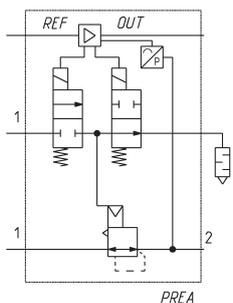
Версия со встроенным клапаном аварийного сброса и внешним питанием пилотного клапана
