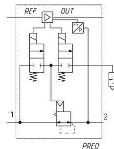
Трехлинейная нормально закрытая версия регулятора с внутренним питанием пилотного клапана (от канала 1)
