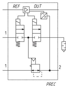
Трехлинейная нормально закрытая версия регулятора с внешним питанием пилотного клапана
