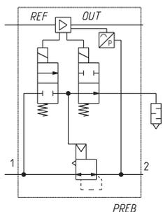
Версия со встроенным клапаном аварийного сброса и внутренним питанием пилотного клапана (от канала 1)
