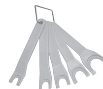
Комплект съёмных ключей для цанги и трубопроводов. В комплекте 5 съёмников под трубопровод с наружными диаметрами 4, 6, 8, 10, 12. Материал – технополимер
