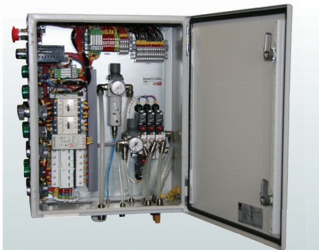
Шкаф управления установкой для запрессовки подшипников Автомобильная промышленность
