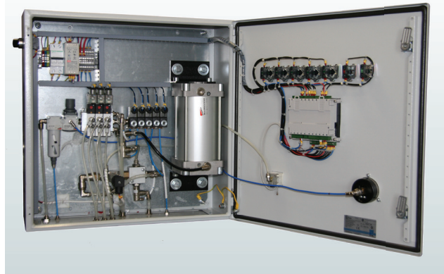
Компактный низкотемпературный шкаф подготовки воздуха Ж/Д
